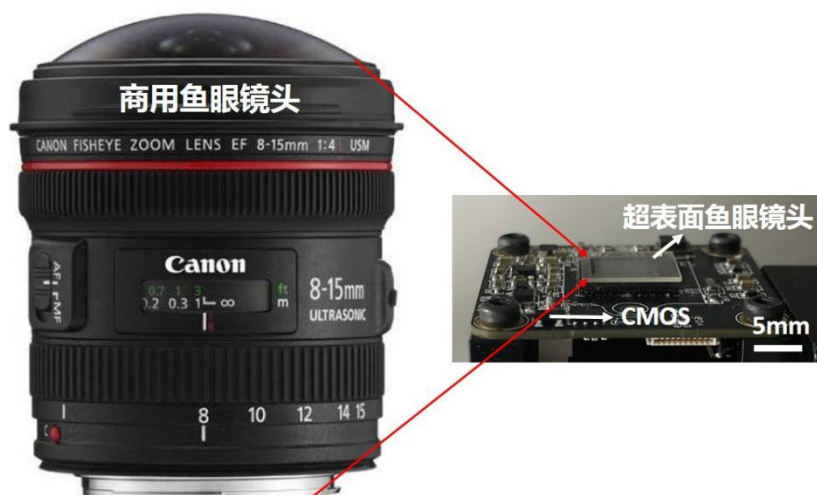
图一 商用鱼镜头与超表面集成广角相机对比
